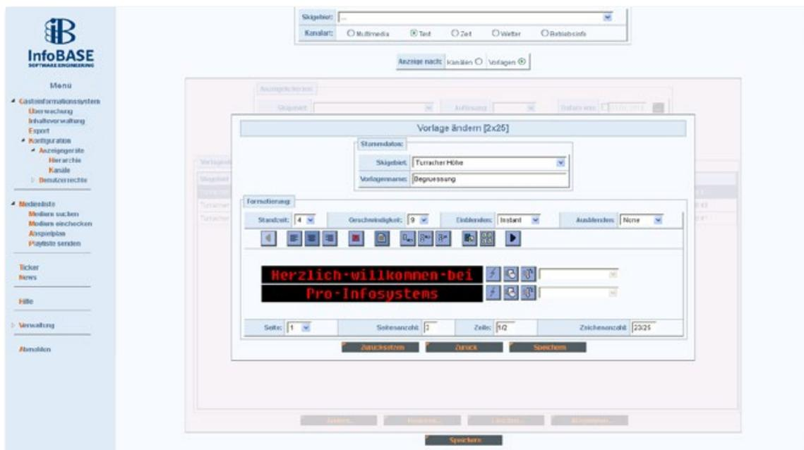
Die Status- und Betriebsanzeigen können entweder manuell von den berechtigten Benutzern oder automatisch nach den vordefinierten Regeln gesteuert werden.
